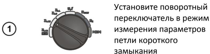
Установите поворотный переключатель в режим измерения параметров петли короткого замыкания
