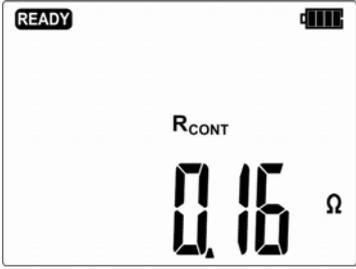
Результат измерения определяется как среднее арифметическое двух значений, полученных при протекании тока в разных направлениях.
